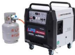
高出力2.2kVAにより、さまざまな用途に対応。10kg容器に接続すれば最大出力で約10時間使用することができます。
